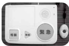
【緊急通報装置】
