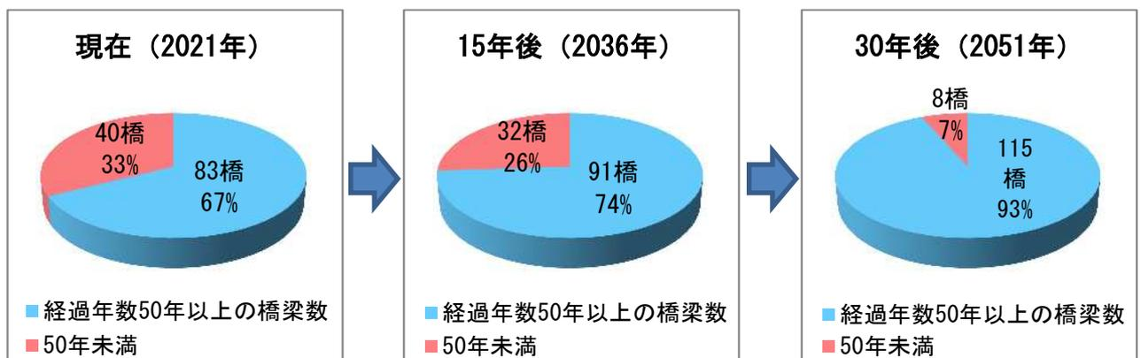
図-1 橋梁の高齢化推移図
