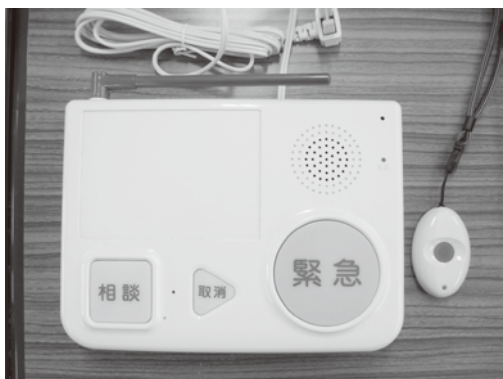
緊急通報装置
