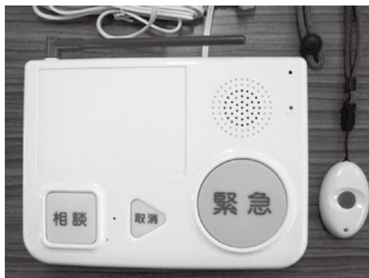
【緊急通報装置とペンダント】
